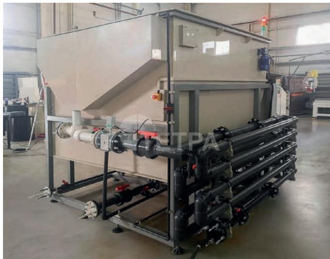
Флотаторы работают по самой практичной и эффективной флотационной технологии – напорной флотации с частичной рециркуляцией стоков.
